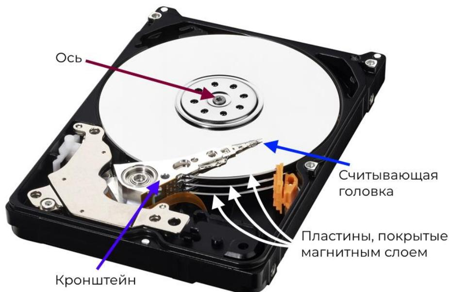
Рисунок 6. Строение жесткого диска
