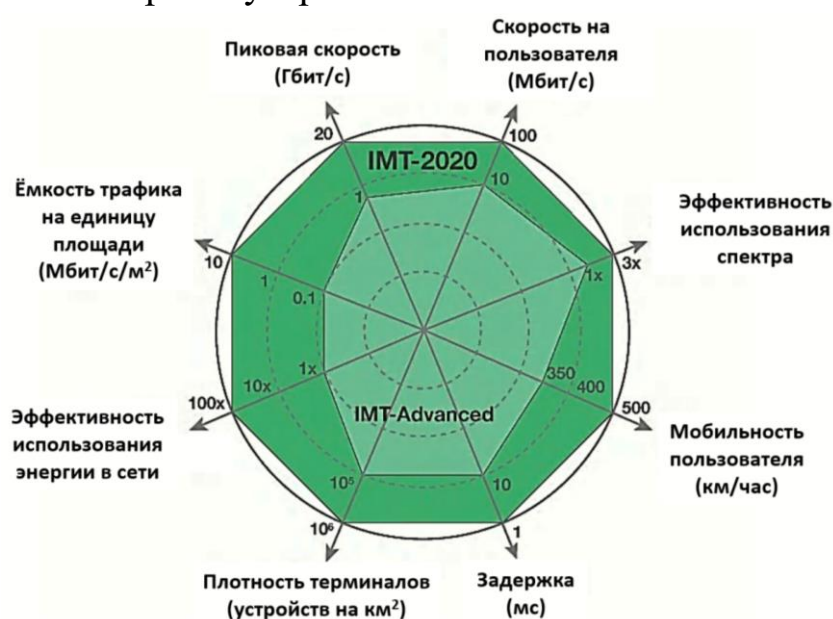
Рис. 2. Расширение ключевых показателей от LTE-A (Long Term Evolution Advanced – улучшенный вариант стандарта мобильной связи «Долговременное развитие») до 5G
